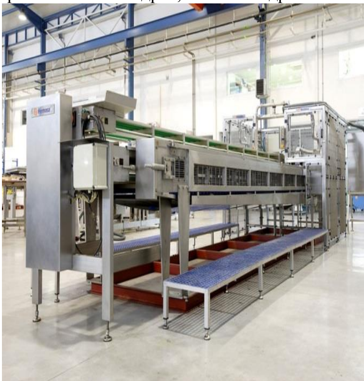
Рис 1.1. Повністю автоматична пакувальна машина для сардин Flash-pack компанії Hermasa
