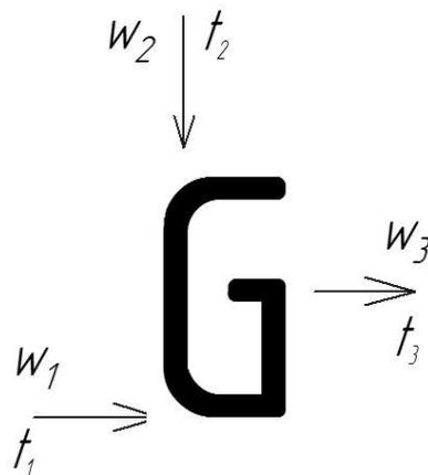
Рідина у першому вхідному штуцері має параметри: швидкість  $w_1=2,0\text{ м/с}$ ,  $t_1=5\text{ }^{\circ}\text{C}$ . Рідина у другому вхідному штуцері має параметри:  $w_2=1,2\text{ м/с}$ ,  $t_2=30\text{ }^{\circ}\text{C}$ .
