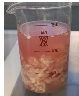
Рис.4. Контрольний зразок після 20 хв. впливу ультразвуку
